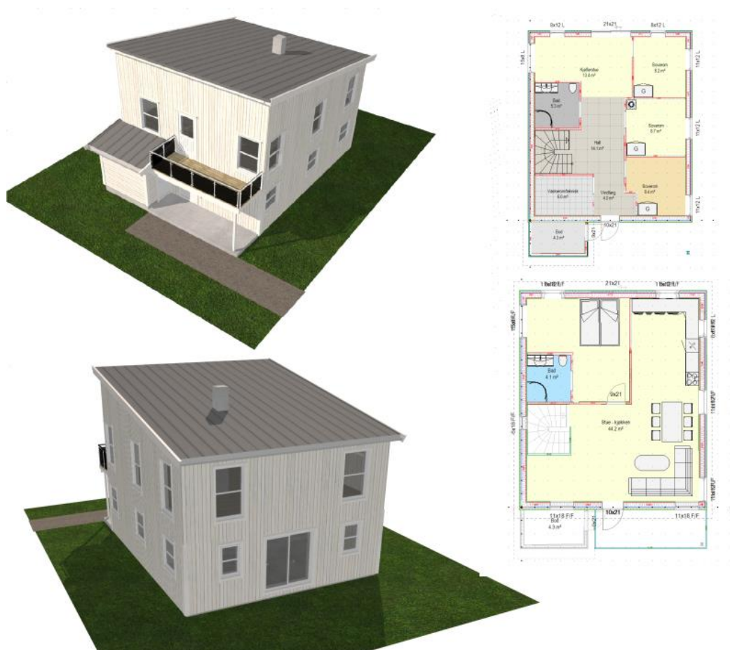
Figur 3-3 Plantegning og prinsippsskisse for «Enebolig, flatt terreng». Kilde: Holte Kalkulasjonsnøkkel.
